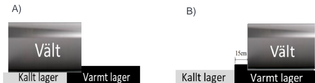
Figur 4. Packningsmetod beroende på vältposition. A) "Cold-to-Hot" (C-H), B) "Hot-to-Cold" (H-C).
