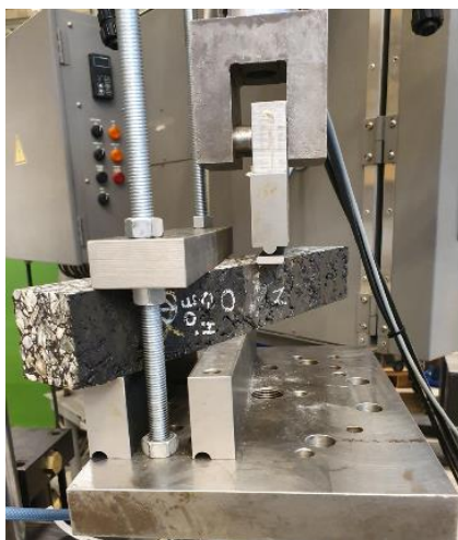
Figur 11. Testning av prover på KTHs asfaltlaboratorium: A) "Cantilever shear test", B) "3-point shear test" (källa: Ehsan Ghafoorirozbahany).
